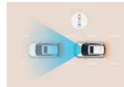
**Forward Collision-avoidance Assist (FCA) con riconoscimento pedoni.** Il sistema FCA avverte del pericolo di un tamponamento e frena, se necessario, in modo indipendente per evitare una collisione o attenuarne le conseguenze, a meno che non si abbia già azionato il freno.
