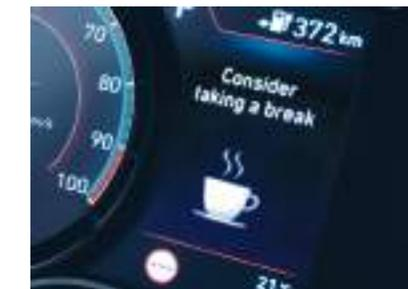
**Driver Attention Warning (DAW).** Il dispositivo DAW accresce la sicurezza monitorando e analizzando costantemente lo stile di guida. Quando identifica segnali di stanchezza o di fatica, il DAW attira l'attenzione del conducente con un segnale acustico e un messaggio visivo che suggerisce di prendersi una pausa.
