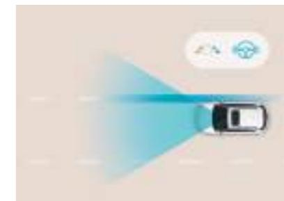
**Lane Keeping Assist (LKA).** Il sistema LKA utilizza la telecamera frontale per monitorare le linee di carreggiata. Nel caso di un involontario spostamento, il sistema allerta il conducente e può applicare una correzione dello sterzo per riportare la vettura all'interno della corsia.
