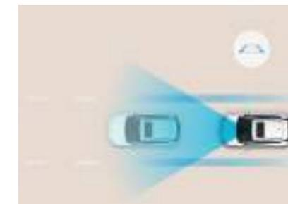
**Lane Following Assist (LFA) con Adaptive Smart Cruise Control (ASCC).** Nuova Kona Electric è dotata di Lane Following Assist. Quando attivato, il sistema usa la telecamera anteriore per mantenere il veicolo al centro della corsia. LFA opera in combinazione con lo Smart Cruise Control per la maggiore comodità del conducente (velocità in cui opera: da 0 a 150km/h).
