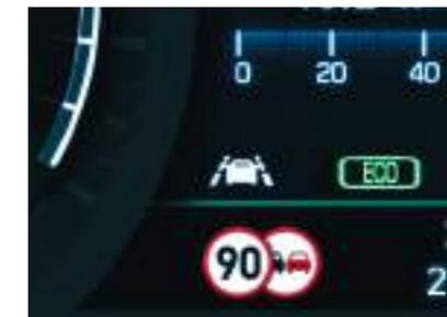
**Intelligent Speed Limit Warning (ISLW).** Il sistema di riconoscimento dei limiti di velocità utilizza la telecamera anteriore e le informazioni provenienti dal sistema di navigazione per identificare i segnali stradali e mostrarti in tempo reale i limiti di velocità e i segnali di divieto di sorpasso.
