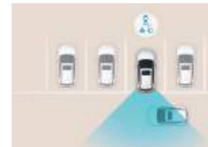
**Rear-Cross Traffic Collision Warning (RCCW).** Quando esci da un parcheggio, il sistema RCCW ti aiuta a ridurre il rischio di collisioni. Utilizzando 2 sensori posteriori, ti avverte al sopraggiungere di altri veicoli.
