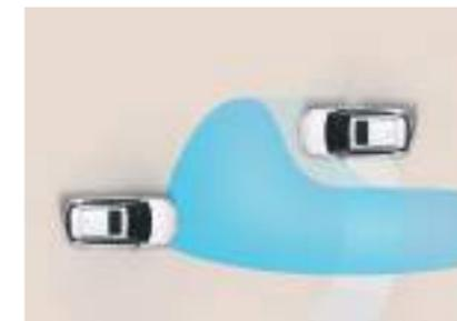
**High Beam Assist (HBA).** Questa funzione di sicurezza individua i veicoli che provengono in senso contrario, così come quelli che precedono, e passa automaticamente dai fari abbaglianti agli anabbaglianti migliorando la sicurezza e la visibilità notturna.
