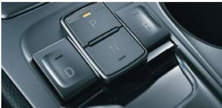
**Tasti shift-by-wire** – Tutto quello che ti serve è "a portata delle tue dita": passa tra le modalità Marcia, Parcheggio, Folle e Retromarcia usando semplicemente i pulsanti posizionati nella console centrale. Anche il freno di stazionamento elettrico si trova nella medesima posizione.
