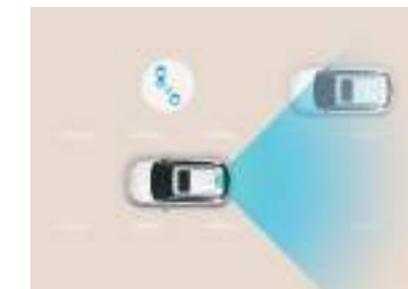
**Blind Spot Detection (BSD).** Utilizzando due sensori collocati sul paraurti posteriore, il sistema segnala visivamente la presenza di veicoli nell'angolo cieco. Inoltre se tu dovessi inserire l'indicatore di direzione in una situazione non sicura, il dispositivo BSD ti avviserà con un segnale acustico.
